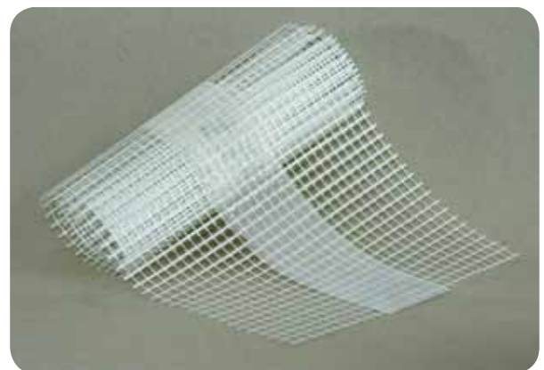
Therm 411 Armeringsbånd Glasfiberarmering til pladesamlinger. BEMÆRK "gazestrimlen" skal vende mod pladen. Fastklæbes med weber.xerm 853 F. Ruller á 20 m.
