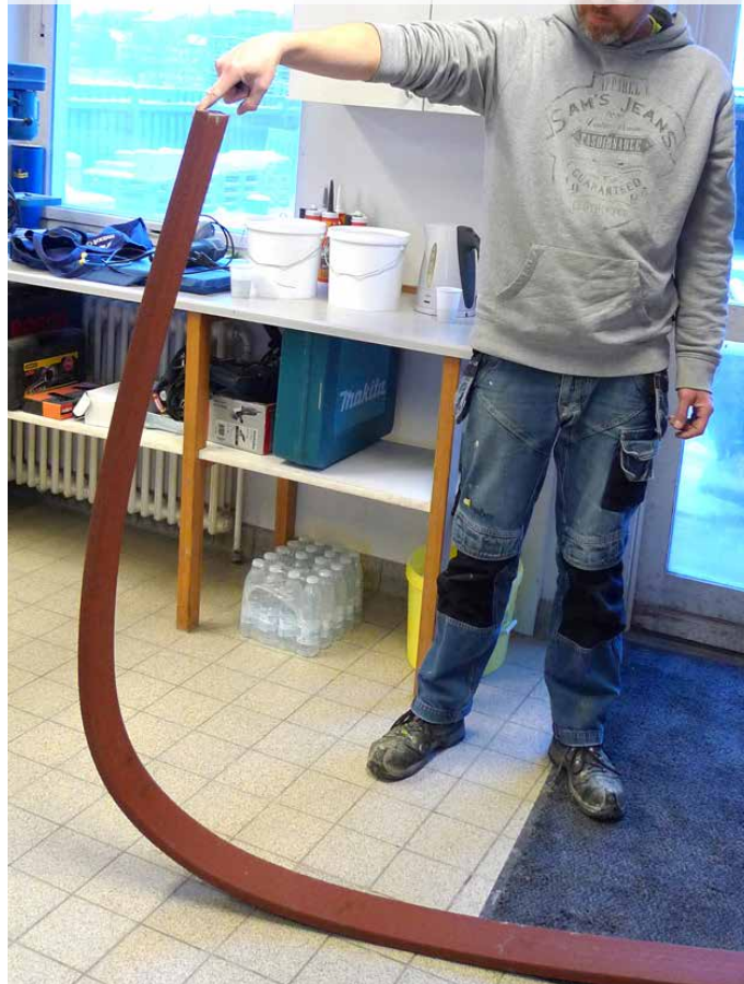
Befæstigelsesplankens bøjningsegenskaber blev testet i laboratoriet.
