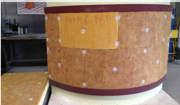
En mockup svarende til bygningens mindste radius blev opført hos Weber, før den blev pudset/malet.
